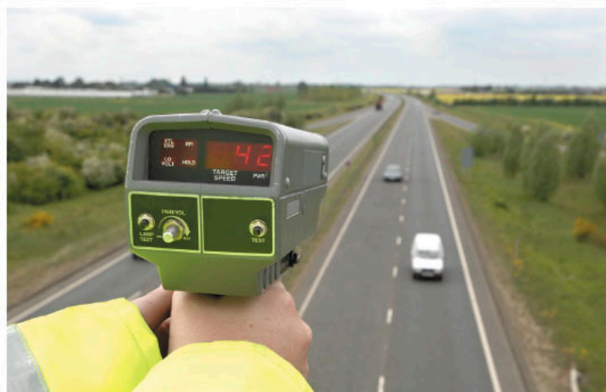
Figura 2 Radar de pistola para medir la velocidad con que circulan los automóviles en una vía rápida
