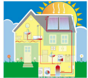
Figura 15.15 Esquema del funcionamiento de un calentador solar para casa
