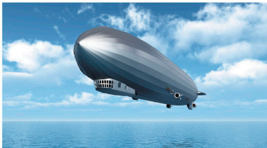
Figura 16.4 Dirigible. El globo es de grandes dimensiones y en la parte inferior se ubica la cabina para el piloto y los pasajeros.
