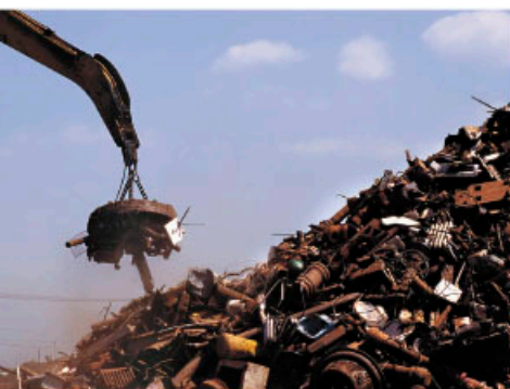
Figura 9.14 Grúa con electroimán para transportar piezas metálicas
