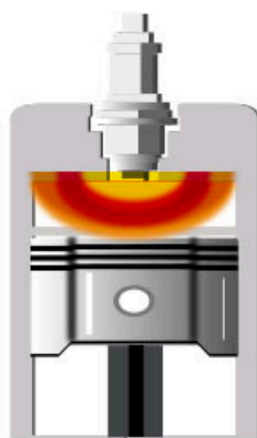
Figura 7.15 Pistón dentro de un cilindro, al que con frecuencia se le llama camisa . El espacio donde se quema el combustible se llama cámara de combustión .
