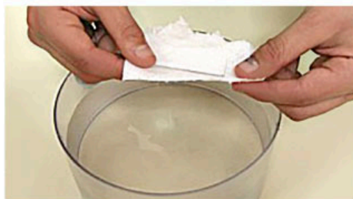
Figura 9.8 La aguja imantada se coloca en el papel de aluminio o el unícel para ponerla a flotar en un recipiente con agua y que pueda girar libremente.
