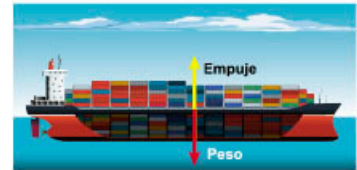
Figura 3.26 El peso es una fuerza descendente que tiende a hundir los objetos cuando se sumergen, y el empuje es una fuerza ascensional que tiende a hacerlos flotar.
